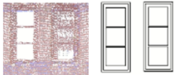
Gambar 10. Perbandingan data point cloud dan objek parameterik dari model 3D.
