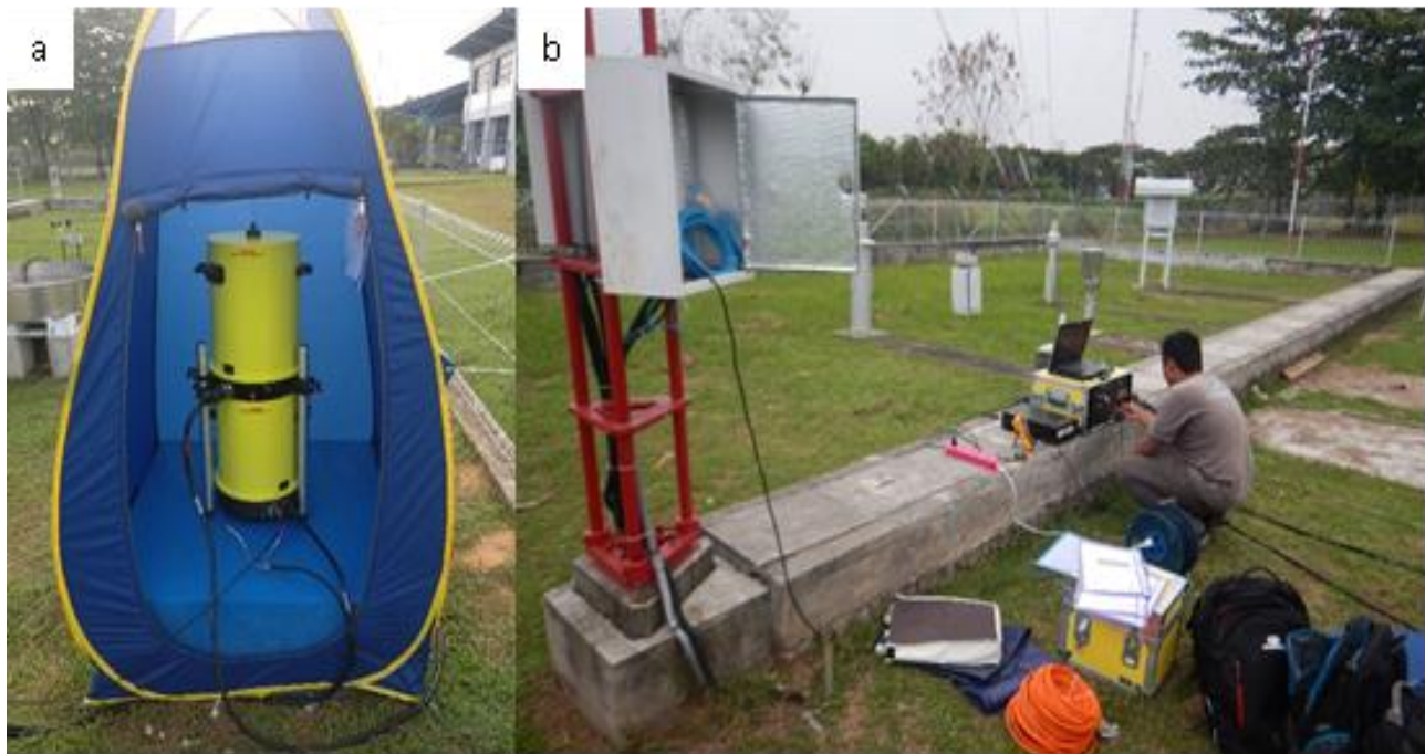
Gambar 2. a) Gravimeter absolut A-10 diletakkan di dalam tenda saat melakukan pengukuran, b) Sumber listrik AC digunakan saat pengukuran.
